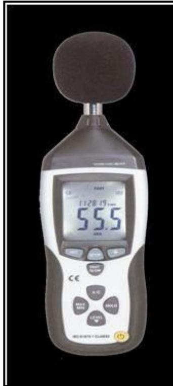
Fotografía 8. Sonómetro Marca Schwyz Modelo SC212-3 ( Schwyz 2016).
