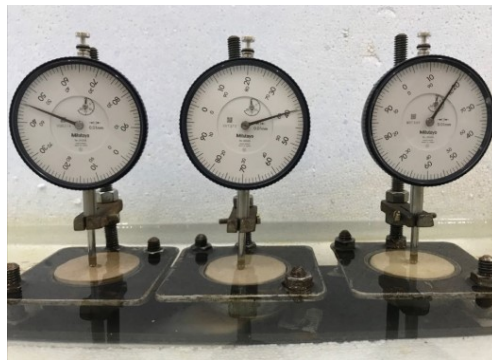
Figura 2.5.1 Configuración de ensayo de expansión unidimensional
