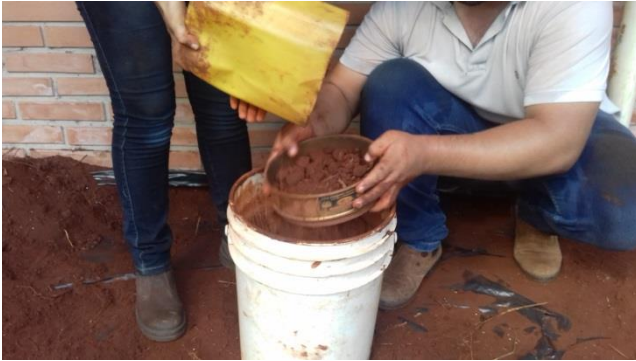
Preparación de macetas. Tamizado y pesaje de suelos, franco arenoso y arcilloso
