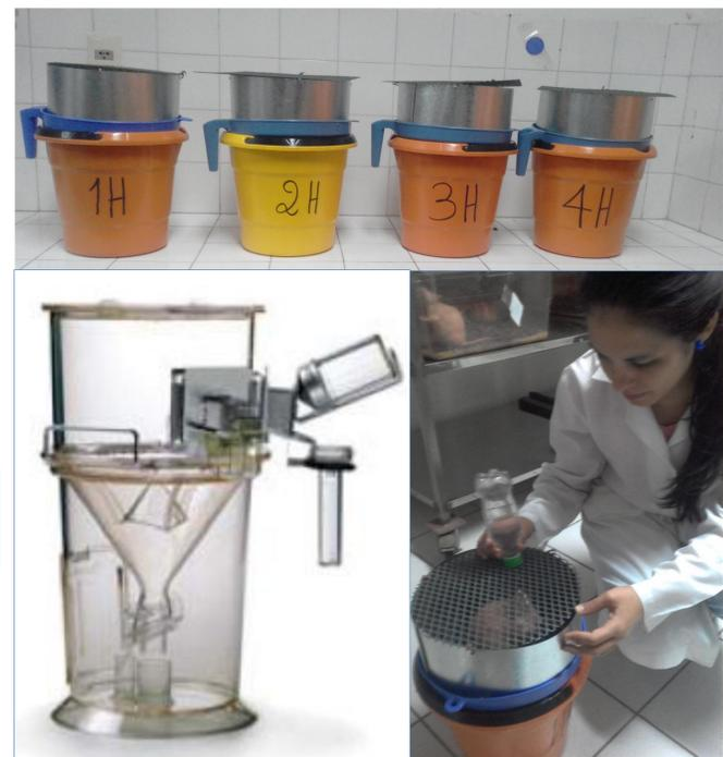
Figura 1. A) Cajas metabólicas caseras, B) Caja metabólica comercial C) Acomodamiento de ratas en las cajas metabólicas caseras.
