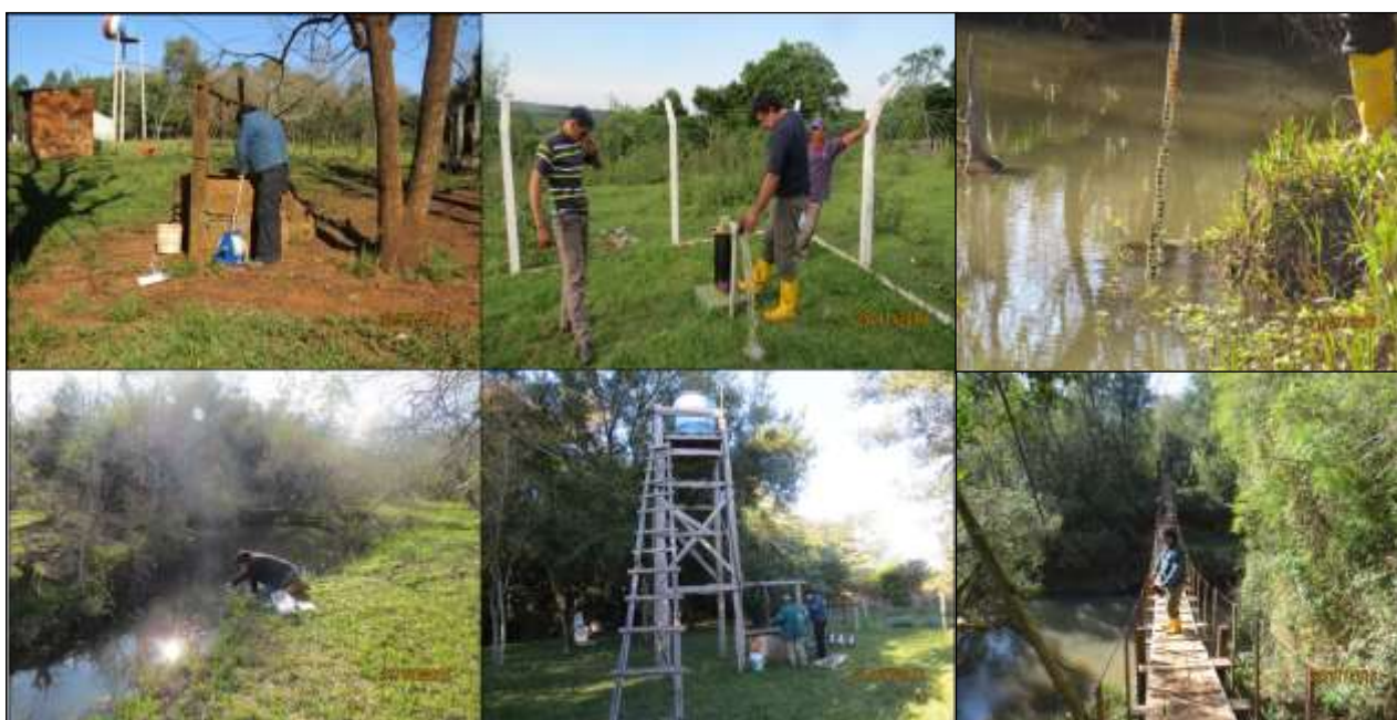
Foto 1. Relevamiento de datos de los pozos (someros y profundos) y cauces de agua con mediciones de pH, CE, OD, T, también ancho y profundidad.
