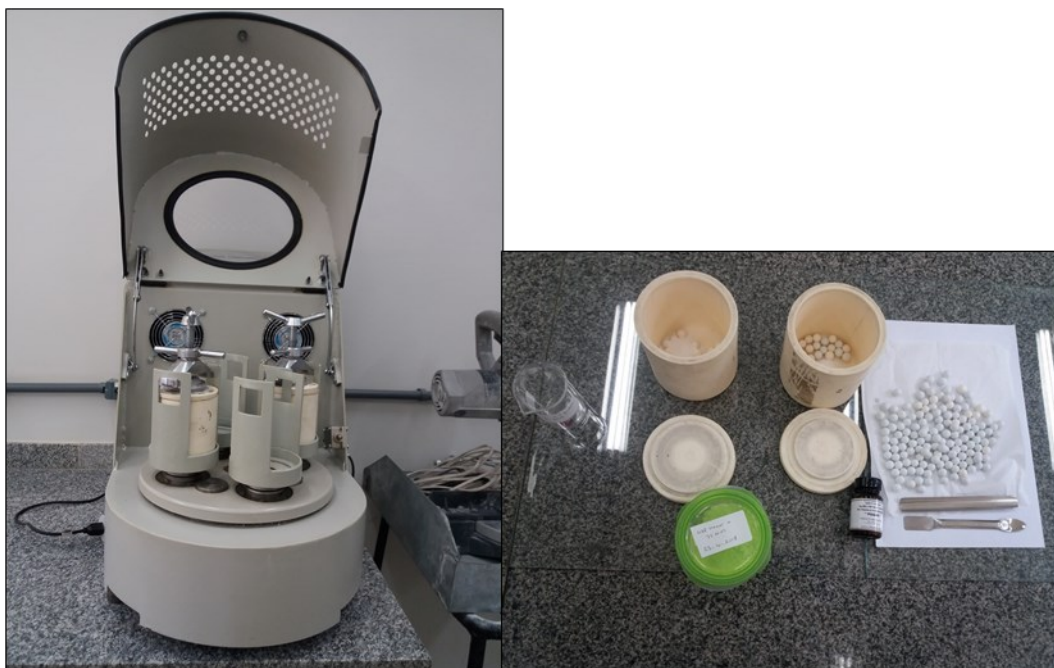
Figura 3: Molino de bolas, jarros y bolas de alúmina utilizadas en la molienda.
