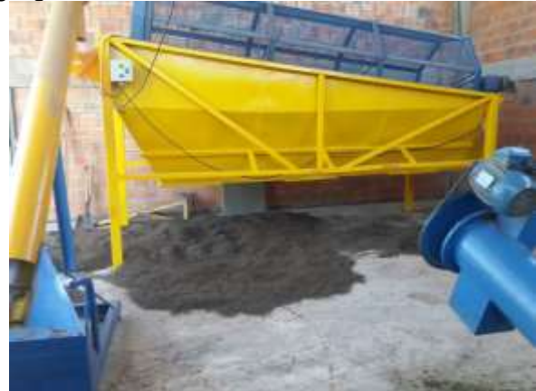
Tornillo de Arquímedes y Tamiz rotativo ortogonal
