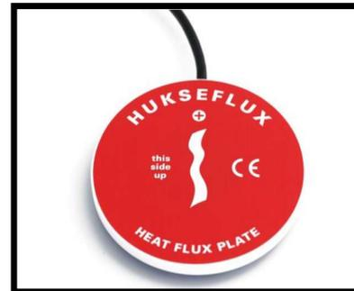
Equipo utilizado para la medición de flujo de calor y temperatura
