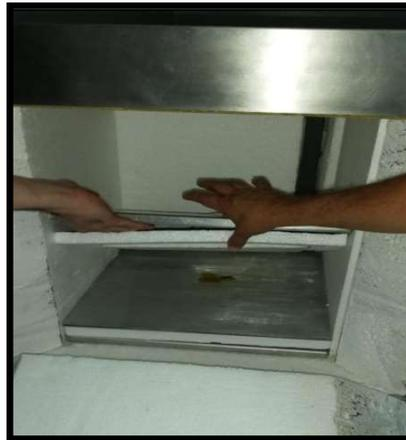
**Placa fria superior y probeta padron2**
