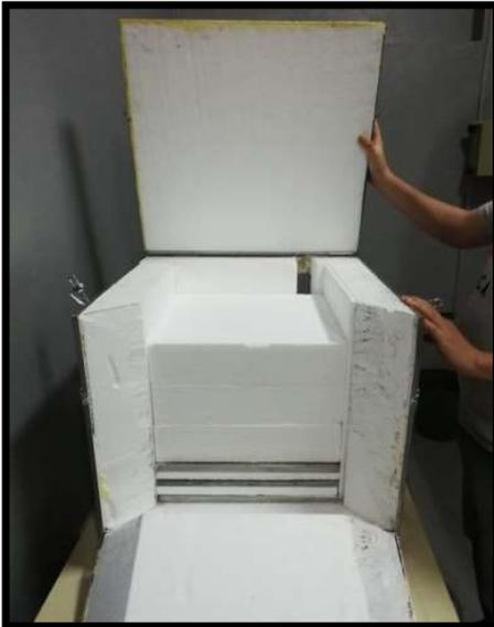
Conformación final del calorímetro
