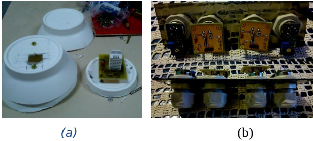
Figura 6. a) Dispositivo de protección. b) Contenedor de los sensores de gases.
