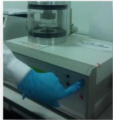
Esta radiación iónica carga la superficie del carbón aumentando su carácter hidrófilo y haciéndolo así capaz de adsorber la proteína. El carbón permanece cargado aproximadamente 30 minutos.
