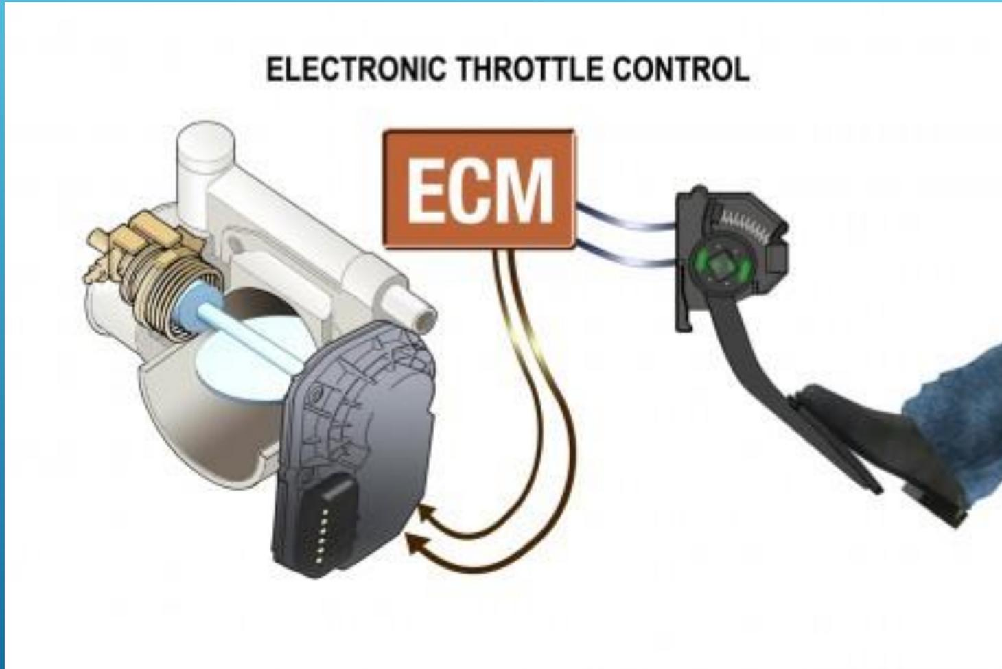
En sistemas de aceleración electrónica, la entrada de aire se controla mediante una señal eléctrica, a medida que cambia la posición del pedal. Esto se da para vehículos a gasolina o vehículos eléctricos
