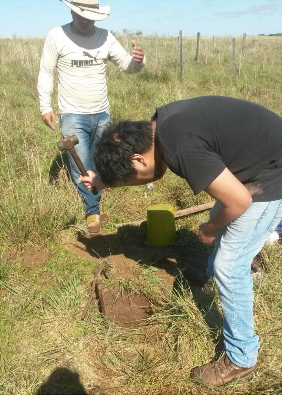
Foto 2. Utilización de barreno calador para obtención de muestras hasta 100 cm de profundidad.
