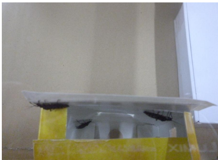
Figura 37. Vinchucas machos capturadas en el ensayo biológico utilizando la pastilla Caolín-T3, a los 19 días de haber comenzado el proceso de liberación de la feromona.
