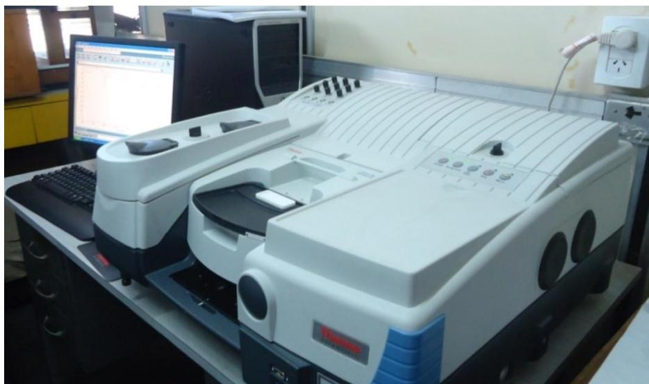
**Figura 1.** Fotografía del Espectrofotómetro FTIR Thermo Scientific - Nicolet 8700, con accesorio ATR.
