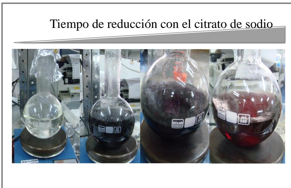
**Figura 12** Reducción de oro coloidal por el ácido cloro áurico. En la figura se observan los cambios de color durante la reducción, de amarillo claro, negro a rojo vino.
