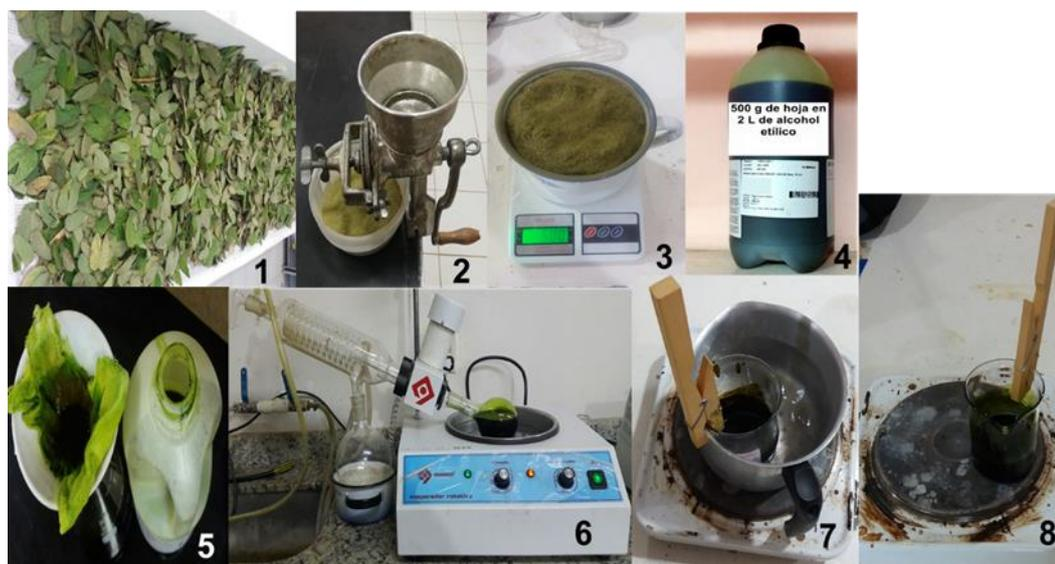
**Anexo E: Preparación del extracto etanólico de *Bauhinia forficata* Link.** (1) Secado. (2) Proceso de pulverización con ayuda de molino manual. (3) Hojas pulverizadas y pesadas. (4) Disolución en 2 L de etanol al 70%. (5) Filtrado. (6) Concentración del extracto con ayuda de evaporador rotativo, (7) baño maría y (8) calentamiento directo sobre la placa.
