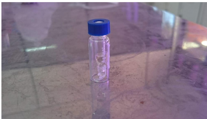
5. Líquido extractante en el inserto para ser analizado en el GC-FID.
