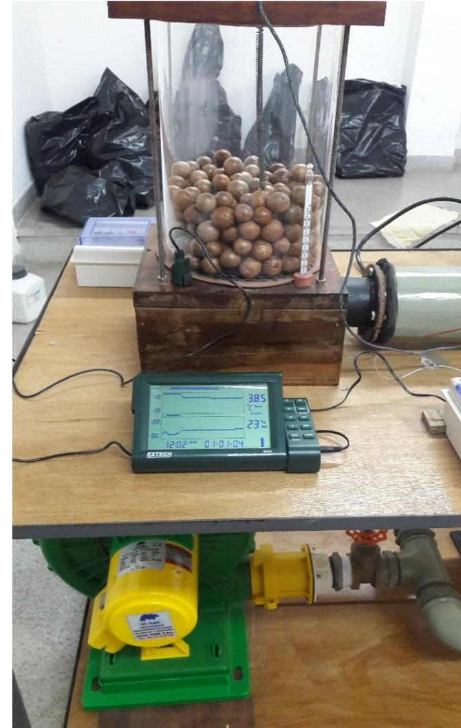
*Caudal de aire: 0,932 a 1,042 m<sup>3</sup>/min (0,5 a 0,55 m/s)*
