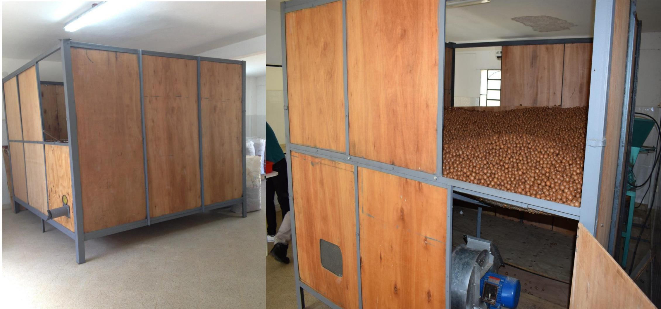
*SECADERO CON VENTILADOR, AIRE A TEMPERATURA AMBIENTE*
