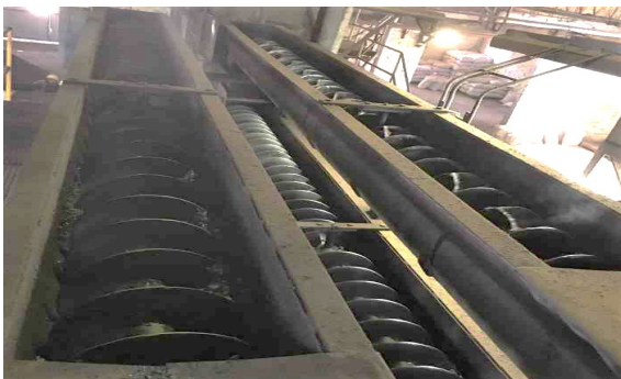
Figura 32 – Almendra húmeda (a), conjunto de secadores continuos tipo tornillo superpuestos (b), vista superior de secadores de tornillo (c).
