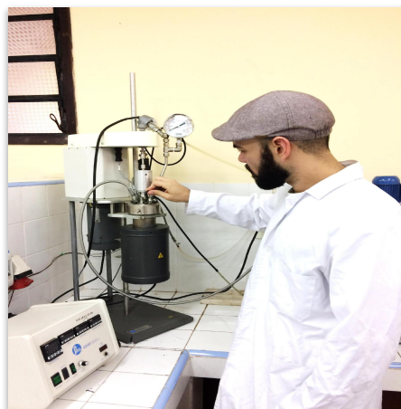
Figura 44 – Reacción de esterificación y transesterificación de aceite de pulpa mbokaja en reactor Parr.
