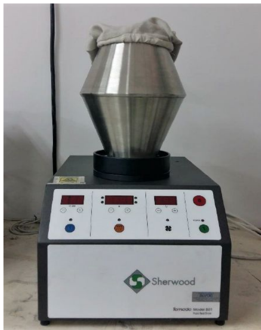
Figura 15 – Secador tipo silo con velocidad de aire y temperatura variable utilizado en los experimentos.
