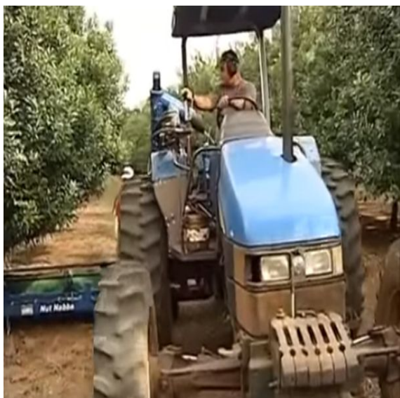
Figura 11 – Máquina para recolección de nuez de macadamia. Fuente: Metalurgica LF (Argentina).
