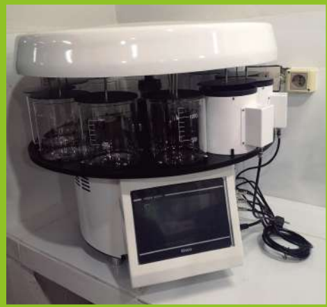
Equipo Procesador Automático de Tejidos: deshidratación muestras.
