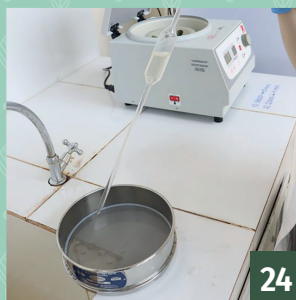
Figura 14. Método de extracción flotación-centrifugación en solución de sacarosa modificado de Jenkins (1964). (Continúa)
