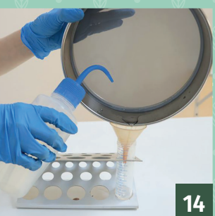
Figura 15. Método Embudo de Baermann para lo colectado en los tamices 20 y 60 mesh.
