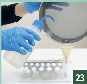
Figura 16. Extracción de nematodos de las raíces con el embudo de Baermann (1917).
