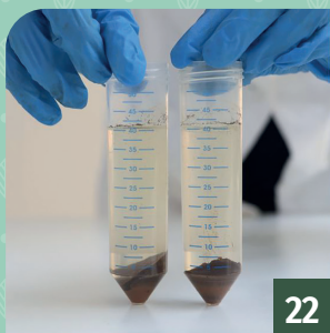
Figura 14. Método de extracción flotación-centrifugación en solución de sacarosa modificado de Jenkins (1964). (Continúa)
