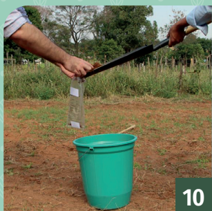
Figura 12. Toma de muestra de suelo con pala.
