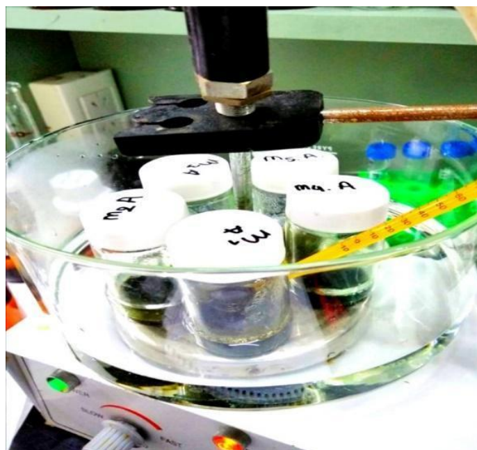
Figura 7. Sistema de reactores batch de vidrio de 50 ml utilizados en el proceso de hidrólisis de cepas. La foto corresponde al conjunto de hidrólisis con enzima Alcalase 2,4 L
