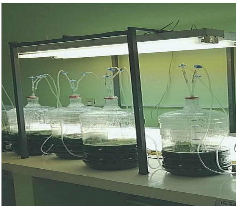
Figura 5. Fotobiorreactores utilizados para el cultivo de Arthrospira platensis
