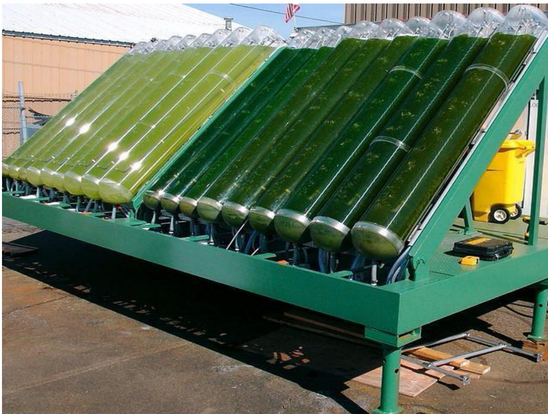
Figura 2. Cultivo de Arthrospira sp en un sistema cerrado tipo fotobiorreactor. Fuente:(Rodríguez, 2010)
