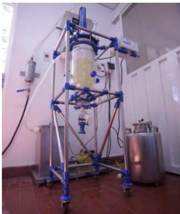
Un biorreactor (foto) es un recipiente o sistema que mantiene los componentes biológicamente activos.
