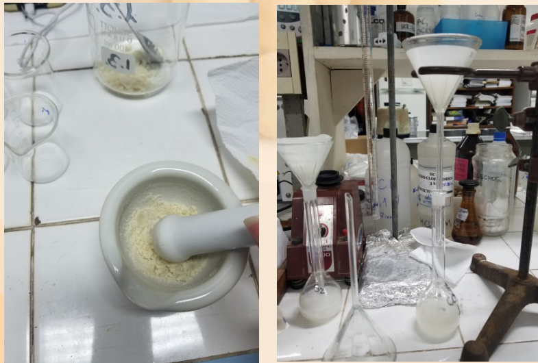
Figura 20. Análisis de azúcares solubles por el método de la Antrona de Clegg. Preparación de la muestra. B) Reacción del reactivo de antrona.
