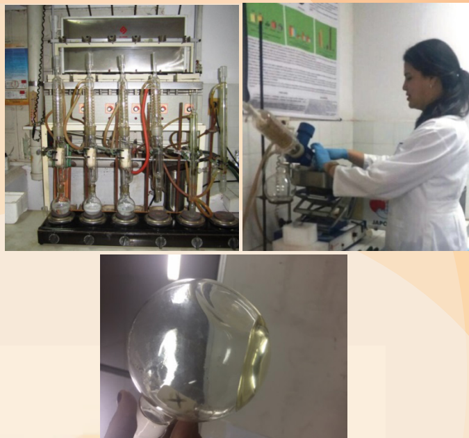
Figura 15. Proceso de extracción de aceite de macadamia para determinación de lípidos totales por Soxhlet.
