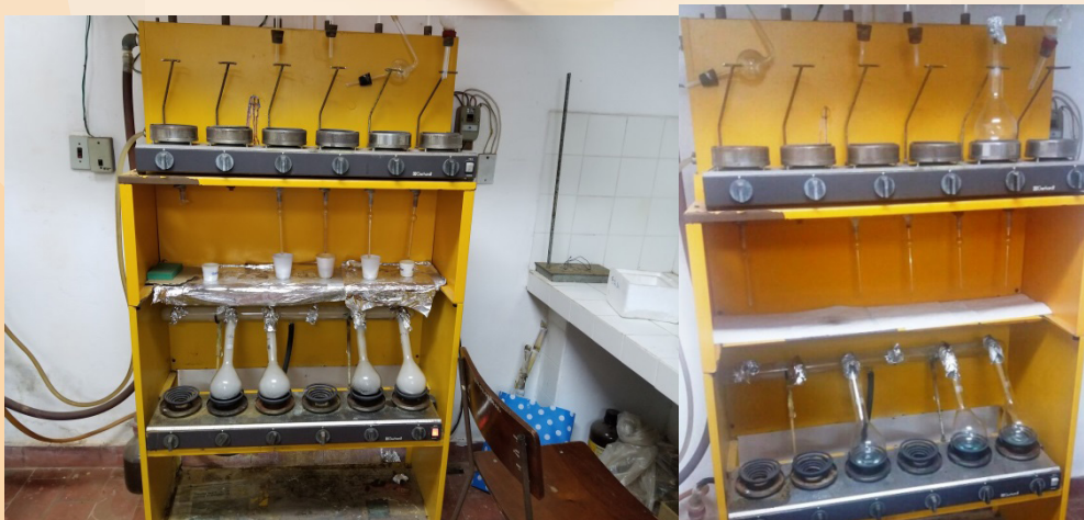
Figura 16. Sistema de Kjeldhal para la determinación de Proteínas, abajo, para la digestión y arriba para la destilación de \text{N}_2 .
