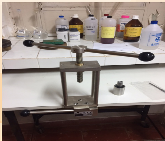
Figura 7. Sistema de extracción de matrices alimentarias para análisis, prensa Food PRESS CDR S.R.L.(Firenze, Italia).
