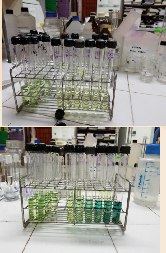
Figura 21. Análisis de azúcares solubles por el método de la Antraona de Clegg. A) Preparación de la muestra. Reacción de la muestra con el reactivo antraona en medio sulfúrico.
