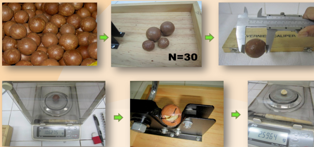
Figura 5 Procedimiento de análisis de las características físicas de la NIS y el Kernel de macadamia, medición del tamaño de la nuez.
