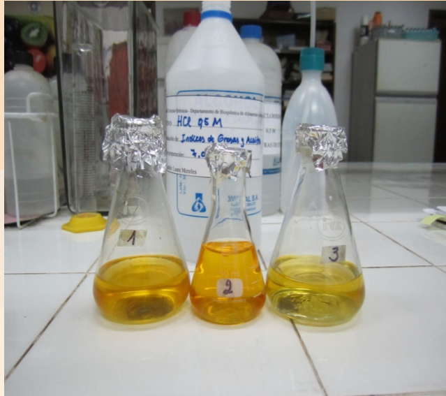
Figura 17. Punto final de la titulación por retroceso con NaOH, para la cuantificar el contenido de nitrógeno total.
