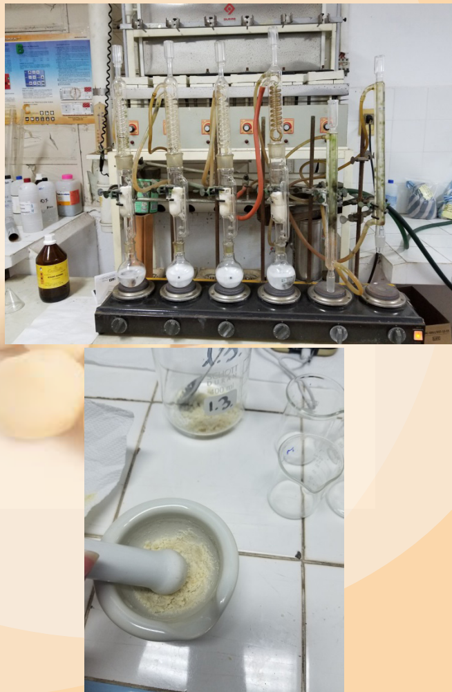
Figura 19. Extracción de la muestra seca y desengrasada desde el cucurucho del Soxhlet para la determinación de fibra alimentaria.
