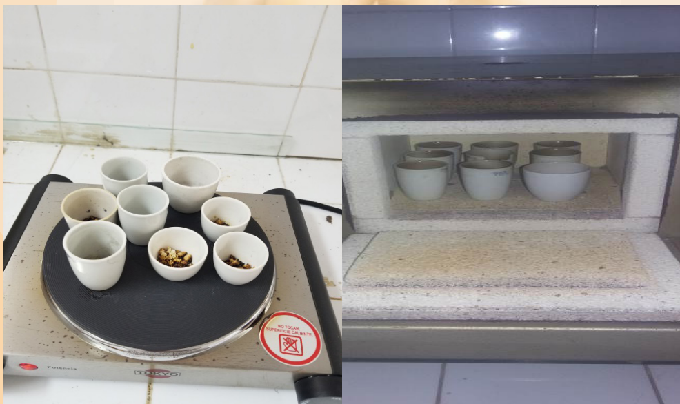
Figura 18. Proceso de calcinación de la materia orgánica de muestras en planchas calefactora y mufla a 550°C para determinación de ceniza.
