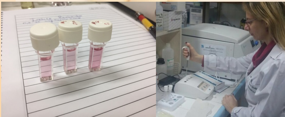
Figura 11. Determinación de acidez en aceite de macadamia recién extraído en equipo OXITESTER Junior.
