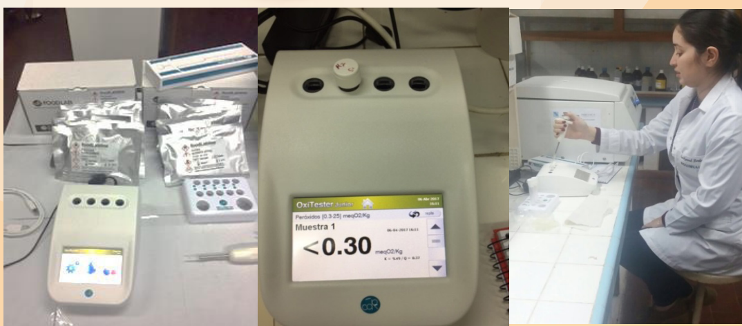
Figura 10. Determinación de índice de peróxidos en aceite de macadamia recién extraído en el equipo OXITESTER Junior.
