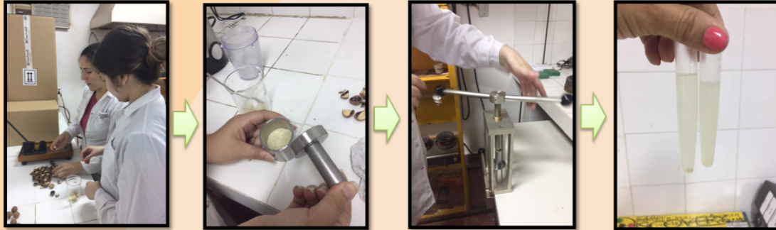
Figura 8. Sistema de extracción de matrices alimentarias para análisis, prensa Food PRESS CDR S.R.L.(Firenze, Italia) y una centrifugadora marca IRIS-ON Everex S.R.L.(Firenze, Italia).
