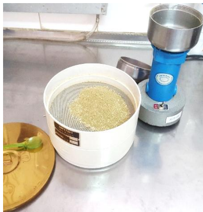
Figura 1: Tamiz de malla N° 40 con apertura de 420 \mu . Molino modelo FW 100.
