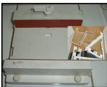
Figura 34. Cama para preparar geles para electroforesis.
