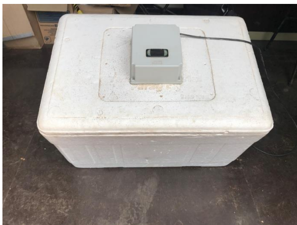
Figura 3-9 –Control de temperatura de curado ( 40^\circ \text{C} )
