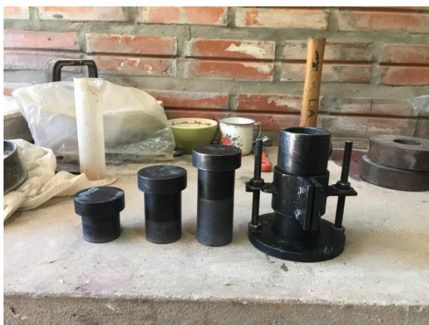
Figura 3-8 –Molde cilíndrico de acero de 50 mm de diámetro por 100 mm de altura
