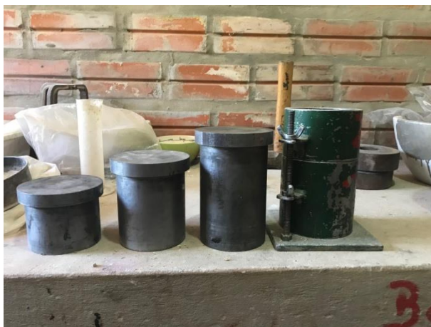
Figura 3-7 - Molde cilíndrico de acero de 100 mm de diámetro por 116 mm de altura
