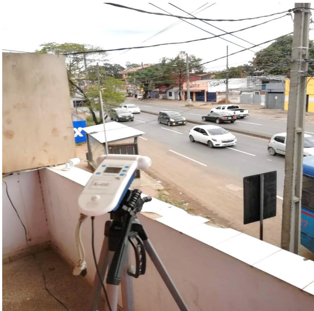
Figura 5. Montaje del equipo AEROQUAL® Monitor Serie 500 con sensor de ozono, medición de temperatura y humedad relativa del aire.
